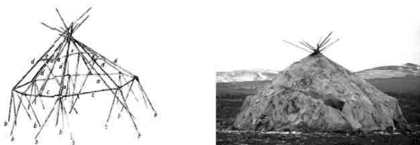
Рис. 3. Схема конструкции и внешний вид яранги
