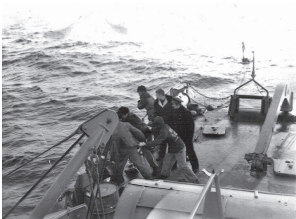
Морская работа. Идет постановка контактного траля МКТ-2, Баренцево море, 1978 год
